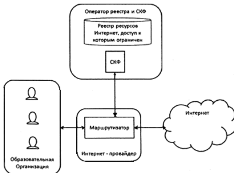
Рис.5. Схема работы контент-фильтрации при едином решении
